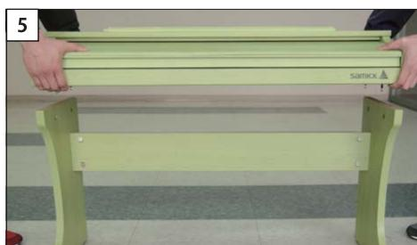
組み立てた本体スタンドを先に立てておき、スタンド上面の穴に鍵盤のカムネジの位置を合わせて鍵盤を載せます。それからカムロックをSL/SR/パネルの穴(大き目)に差し込みます。
