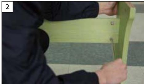
SBパネル側面の穴に合わせて、SL/SRパネルに固定したカムネジをパネルごと差し込みます。次にカムロックをSBパネルのカムロック用(大き目)の穴に差し込み、カムネジがカムロックの内側に入った状態で、カムロックをプラスドライバーを使って時計回りに約180° 程回すとロックされます。
