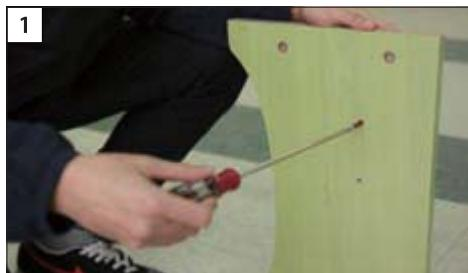
SLパネルとSRパネルのカムネジ用(小さ目)の穴に、カムネジをプラスドライバーでしっかりと固定します。
