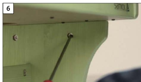
カムロックをプラスドライバーを使って時計回りに約180° 回し、カムネジをロックします。
