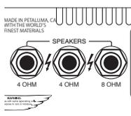
もし本機と他ブランドのキャビを接続するときは、キャビのインピーダンス(抵抗値)をしっかり確認して、正しく安全にアンプと接続しなければなりません。間違った接続をすると真空管の寿命を縮め、アウトプットトランスに過度の負荷をかけてしまい、ダメージを与える危険性があります。間違ったインピーダンスのマッチングによる製品のダメージは保証対象外となりますので十分注意して下さい。また、お使いのスピーカーキャビネットがアンプのスピーカーアウトに正しく接続されているか常に確認して下さい。このマニュアルに後述されている"
