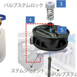
ステムジョイントが動かない様に固定し、③のバルブステムロックを左に回し取り外します。
